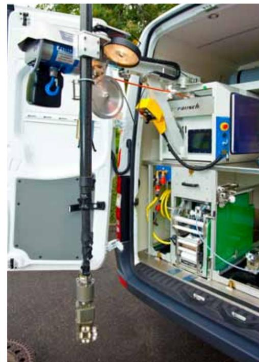
Ispezione di pozzetti con la telecamera principale KS 135 secondo EN13508-2. Telecamera guidata mediante un'asta telescopica fissata sul tamburo cavo ELKA 600.
